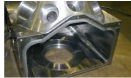
難削材加工 SUS304削り出し
